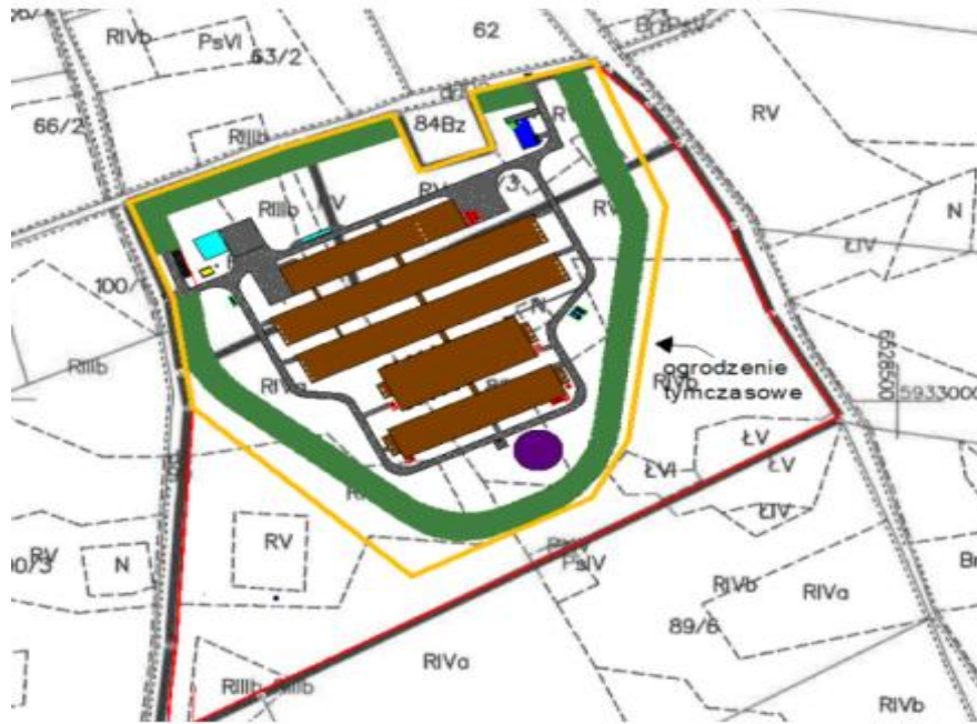
Rys. 1. Lokalizacja ogrodzenia tymczasowego (kolor żółty).
