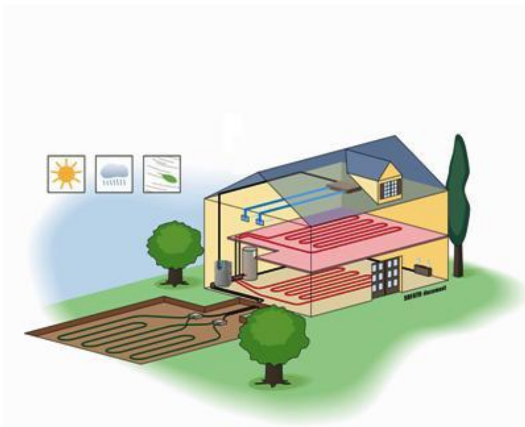
Rys. 4.18. Przykładowy, uproszczony schemat instalacji z pompą ciepła
